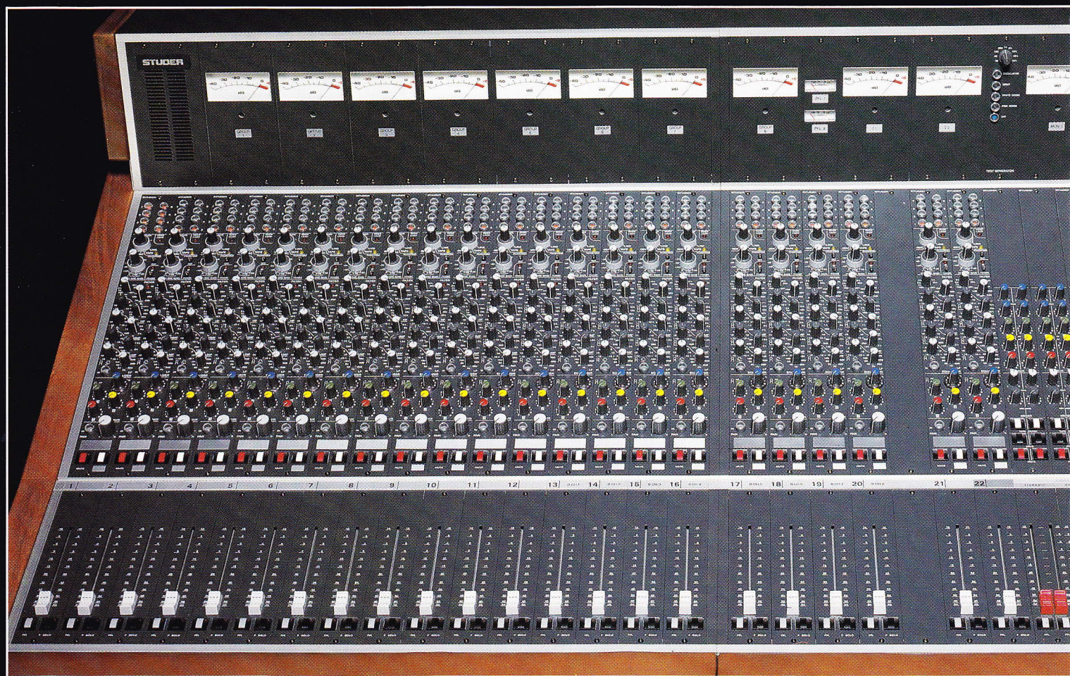
Beispiel eines Spezial-Regiepultes, Typ 902, mit 22 Eingangs- und 8 Gruppen- sowie 2 Summeneinheiten.
